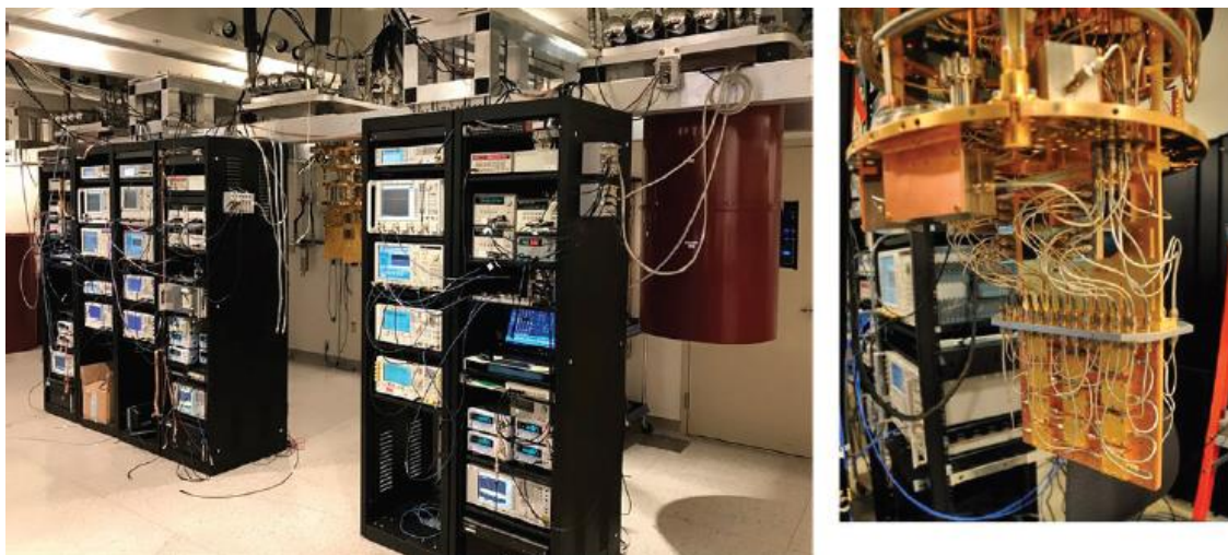
Рис. 2.3. Лабораторное оборудование для современной системы сверхпроводящих кубитов [39].
